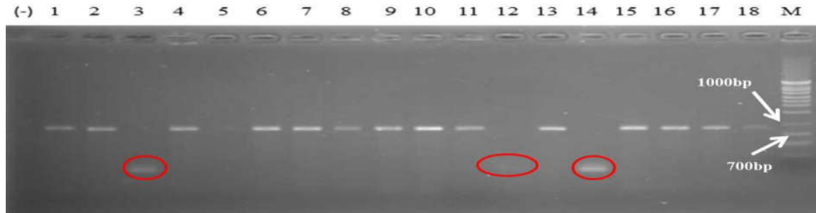
Hình 6. Kết quả sàng lọc các dòng khuẩn lạc mang gen TES-30 được sửa bằng kỹ thuật PCR khuẩn lạc.
